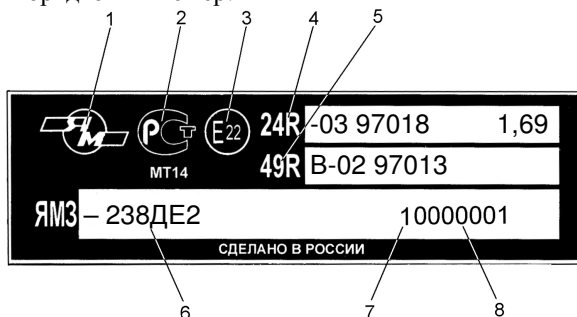
Рис. 49. Заводская табличка двигателя ЯМЗ-238ДЕ2.
