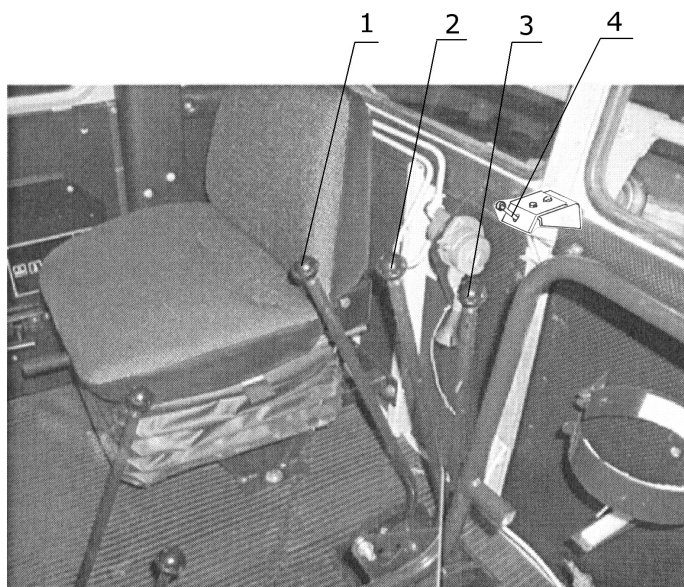
Рис. 4 Рычаги управления гидроцилиндрами рабочего оборудования
